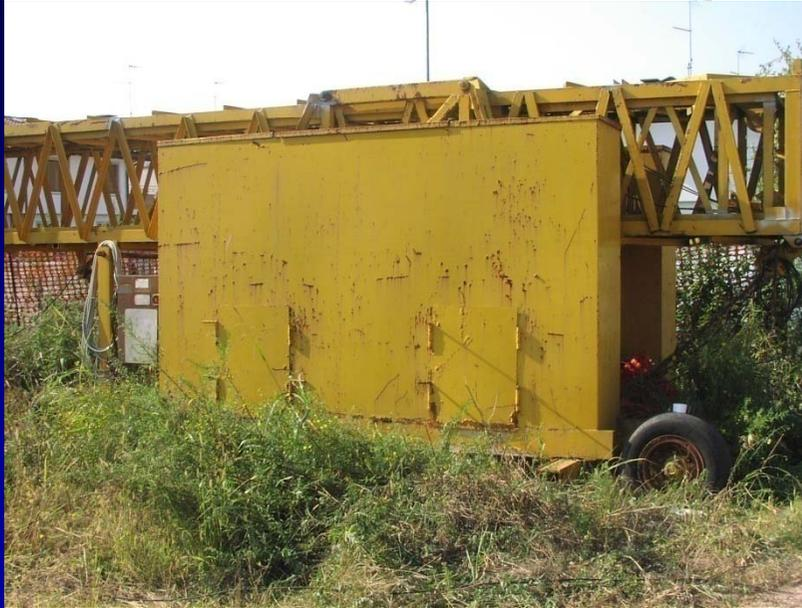
Situazione di degrado del carro di base di una vecchia gru a torre per edilizia a rotazione in alto, concepita ancora con i cassoni in lamiera per il contenimento della zavorra di base
