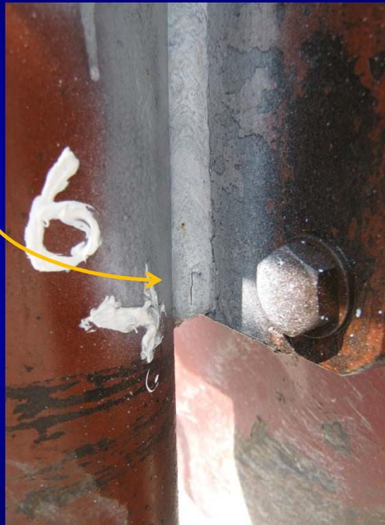
Il non corretto posizionamento degli stabilizzatori durante le fasi di lavoro, l'avanzamento su terreni irregolari e/o gli errori di manovra, possono determinare la formazione di cricche in corrispondenza delle sezioni di attacco alla struttura di base dell'autocarro
