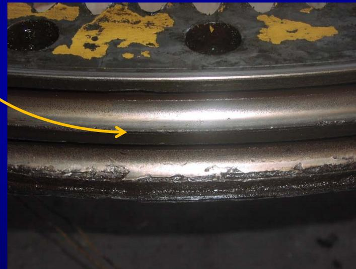
La compromissione della regolare funzionalità della ralla di rotazione di una gru a torre può evidenziarsi già attraverso le indagini esterne (misura del gioco, rumori anomali, difficoltà di scorrimento). Lo smontaggio permette di stabilire il livello reale di affidabilità residua
