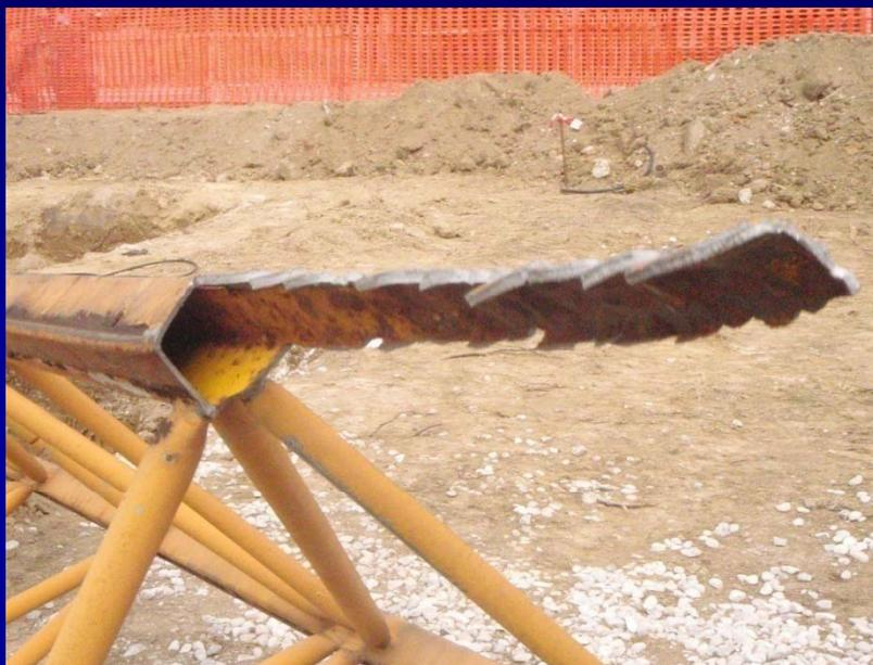
*E, ancora: “le prove devono essere ritenute soddisfacenti se nessuna lesione, deformazione permanente, sfaldamento di vernice o danno che influisca sul funzionamento e la sicurezza dell’apparecchio di sollevamento sia visibile ad occhio nudo e se nessun collegamento si sia allentato o sia rimasto danneggiato”*
